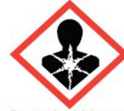
Serious health hazard Ernsthafte Gesundheitsgefährdung Très dangereux pour la santé
